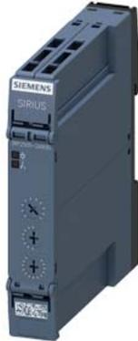
relè a tempo, multifunzione 1 contatto CO, 13 funzioni 7 campi di temporizzazione (0,05 s...100 h) AC/DC 12-240 V a AC 50/60 Hz con LED morsetto a molla (Push-in)
