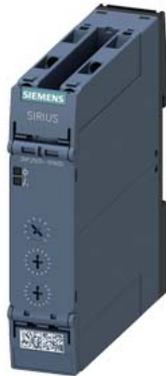
relè a tempo, multifunzione 2 contatti CO, 13 funzioni a guida forzata contatti di relè AC/DC 24...240 V a AC 50/60 Hz 7 intervalli di tempo (0,05 s...100 h) con LED, morsetto a vite
