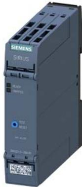
relè protezione motore a termistore unità di controllo standard custodia 22,5 mm morsetto a molla 2 contatti CO US = AC/DC 24 V reset manuale/automatico/remoto con omologazione ATEX 2 LEDs (READY/TRIPPED) separazione galvanica sicura tasto Test/RESET sorveglianza rottura conduttore sorveglianza di cortocircuito a prova di mancanza tensione
