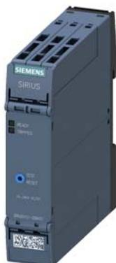
relè protezione motore a termistore unità di controllo standard custodia 22,5 mm morsetto a molla 2 contatti CO bistabili US = AC/DC 24 V ... 240 V reset manuale/automatico/remoto 2 LEDs (READY/TRIPPED) separazione galvanica tasto Test/RESET sorveglianza rottura conduttore sorveglianza di cortocircuito a prova di mancanza tensione
