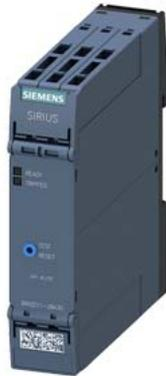
relè protezione motore a termistore unità di controllo standard custodia 22,5 mm morsetto a molla 2 contatti CO US = AC/DC 24 V reset manuale/remoto con omologazione ATEX 2 LEDs (READY/TRIPPED) separazione galvanica tasto Test/RESET sorveglianza rottura conduttore sorveglianza di cortocircuito
