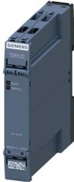
relè protezione motore a termistore unità di controllo compatta custodia 17,5 mm morsetto a vite 1 contatto NO, 1 contatto NC US = AC/DC 24 V RESET automatico adatto per interruttori bimetallici 2 LEDs (READY/TRIPPED) separazione galvanica
