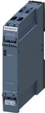
relè protezione motore a termistore unità di controllo compatta custodia 17,5 mm, morsetti a vite, 1 contatto CO, US = AC/DC 24 V, RESET automatico, adatto per interruttori bimetallici, alimentazione=tensione di uscita, 1 LED (intervenuto)
