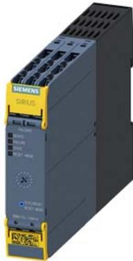
avviatore diretto failsafe, 3RM1, 500 V, 0,55 ... 3 kW, 1,6 ... 7 A, AC 110-230 V, morsetto a vite
