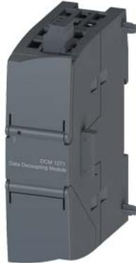
SIMATIC S7-1200, DCM 1271 modulo di disaccoppiamento dei dati per master AS-i CM 1243-2 IN: DC 24 V / 30 V OUT: 1x AS-Interface, 4 A protezione da sovraccarico integrata riconoscimento integr. dei guasti verso terra contatto di segnalazione
