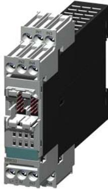
SIRIUS, modulo di ampliamento 3RK33 per sistema di sicurezza modulare 3RK3 8 DI, DC 24 V parametrizzabile tramite MSS ES larghezza costruttiva 22,5 mm morsetto a vite senza cavo di collegamento
