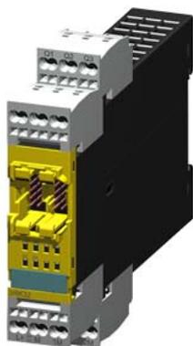
SIRIUS, modulo di ampliamento 3RK32 per sistema di sicurezza modulare 3RK3 4 F-DO, DC 24 V/ 2 A parametrizzabile tramite MSS ES larghezza costruttiva 22,5 mm morsetto a molla fino a SIL3 (IEC 61508) fino a Performance Level E (ISO 13849-1) senza cavo di collegamento
