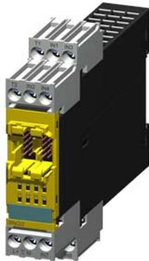
SIRIUS, modulo di ampliamento 3RK32 per sistema di sicurezza modulare 3RK3 2/4 F-DI, 2 F-DO, DC 24 V/1,2 A parametrizzabile tramite MSS ES larghezza costruttiva 22,5 mm morsetto a vite fino a SIL3 (IEC 61508) fino a Performance Level E (ISO 13849-1) senza cavo di collegamento
