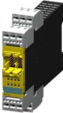
SIRIUS, modulo di ampliamento 3RK32 per sistema di sicurezza modulare 3RK3 2/4 F-DI, 1/2 F-RO, DC24 V/1 A parametrizzabile tramite MSS ES larghezza costruttiva 22,5 mm morsetto a molla fino a SIL3 (IEC 61508) fino a Performance Level E (ISO 13849-1) senza cavo di collegamento
