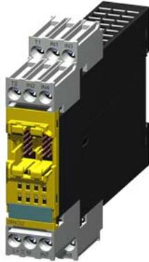
SIRIUS, modulo di ampliamento 3RK32 per sistema di sicurezza modulare 3RK3 2/4 F-DI, 1/2 F-RO, DC 24 V/1 A parametrizzabile tramite MSS ES larghezza costruttiva 22,5 mm morsetto a vite fino a SIL3 (IEC 61508) fino a Performance Level E (ISO 13849-1) senza cavo di collegamento
