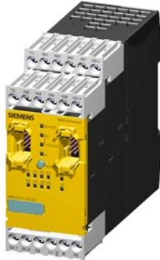
SIRIUS, modulo centrale 3RK3 advanced per sistema di sicurezza modulare 3RK3 4/8 F-DI, 1F-RO, 1 F-DO, DC 24 V monitor di slave ASI comando di 12 uscite sicure su bus AS-Interface parametrizzabile con SW Safety ES larghezza costruttiva 45 mm morsetto a vite fino a SIL3 (IEC 61508) fino a Performance Level E (ISO 13849-1) 9 moduli di ampliamento collegabile
