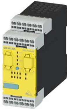
SIRIUS, modulo centrale 3RK3 ASIsafe Basic per sistema di sicurezza modulare 3RK3 1/2F-DI,6DI,1F-RO,1F-DO,DC 24 V monitor di slave ASI comando di 8 uscite sicure su bus AS-Interface parametrizzabile con SW Safety ES larghezza costruttiva 45 mm morsetto a molla fino a SIL3 (IEC 61508) fino a Performance Level E (ISO 13849-1) nessun modulo di ampliamento collegabile
