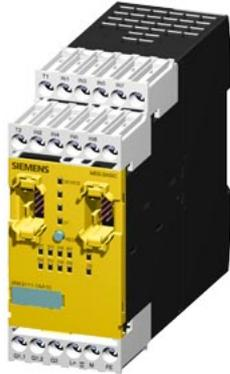
SIRIUS, modulo centrale 3RK3 Basic per sistema di sicurezza modulare 3RK3 4/8 F-DI, 1F-RO, 1 F-DO, DC 24 V parametrizzabile con SW Safety ES larghezza costruttiva 45 mm morsetto a vite fino a SIL3 (IEC 61508) fino a Performance Level E (ISO 13849-1)
