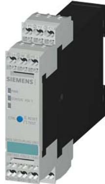
disaccoppiatore dati AS-i 1 x 4 A morsetti a molla, AS-i singolo modulo di disaccoppiamento dei dati IP20, SlimLine S22,5 morsetti a molla larghezza costruttiva modulo 22,5 mm IN: DC 24 V / 30 V OUT: 1 x AS-I, 4 A protezione da sovraccarico integrata rilevamento di guasto verso terra integrato contatto di segnalazione reset remoto
