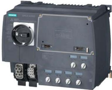
avviatori motore SIRIUS M200D modulo tecnologico avviatore invertitore con commutazione elettromeccanica AC-3, 5,5 kW / 400 V 1,5 A...12,00 A protezione elettronica da sovraccarico termistore: THERMOCLICK / PTC senza contatto del freno 4DI / 2DO Han Q4/2 - Han Q8/0 tramite modulo di comunicazione 3RK1305\* impiegabile su PROFIBUS o PROFINET
