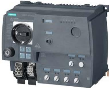
avviatore motore SIRIUS M200D AS-i comunicazione: interfaccia AS avviatore invertitore standard con commutazione elettromeccanica AC-3, 5,5 kW / 400 V 1,5 A...12,00 A protezione elettronica da sovraccarico termistore: THERMOCLICK / PTC con contatto del freno AC 400 V 4D1 / 1DO AS-i Han Q4/2 - Han Q8/0 con comando manuale locale e selettore a chiave
