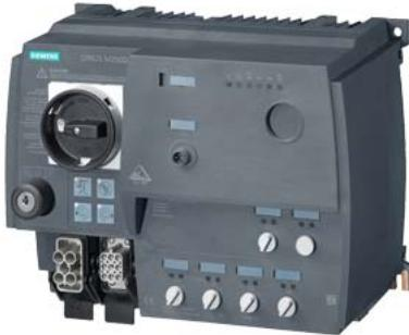
avviatore motore SIRIUS M200D AS-i comunicazione: interfaccia AS avviatore diretto standard con commutazione elettromeccanica AC-3, 5,5 kW / 400 V 1,5 A...12,00 A protezione elettronica da sovraccarico termistore: THERMOCLICK / PTC con contatto del freno AC 400 V 4DI / 1DO AS-i Han Q4/2 - Han Q8/0 con comando manuale locale e selettori a chiave
