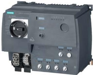
avviatore motore SIRIUS M200D AS-i comunicazione: interfaccia AS avviatore invertitore standard commutazione elettronica AC-3, 0,75 KW / 400 V 0,15 A...2,00 A protezione elettronica da sovraccarico termistore: THERMOCLICK / PTC senza contatto del freno 4DI / 1DO AS-i Han Q4/2 - Han Q8/0
