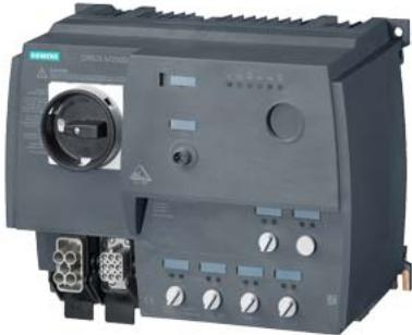
avviatore motore SIRIUS M200D AS-i comunicazione: interfaccia AS avviatore diretto standard con commutazione elettromeccanica AC-3, 0,75 KW / 400 V 0,15 A...2,00 A protezione elettronica da sovraccarico protezione elettronica da sovraccarico termistore: THERMOCLICK / PTC senza contatto del freno 4DI/1DO AS-i Han Q4/2 - Han Q8/0
