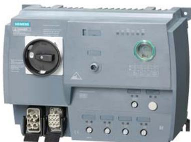
avviatore motore SIRIUS M200D AS-i comunicazione: AS-Interface avviatore invertitore Basic con commutazione elettromeccanica AC-3, 5,5 kW / 400 V 1,5 A...12,00 A protezione elettronica da sovraccarico termistore: Thermoclick / PTC con contatto del freno DC 180 V 2DI AS-i + 2DI / 1DO sul dispositivo Han Q4/2 - Han Q8/0
