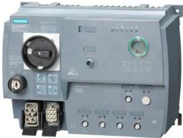
avviatore motore SIRIUS M200D AS-i comunicazione: AS-Interface avviatore diretto Basic con commutazione elettromeccanica AC-3, 0,75kW / 400 V 0,15 A...2,00 A protezione elettronica da sovraccarico termistore: Thermoclick / PTC con contatto del freno AC 400 V 2DI AS-i + 2DI / 1DO sul dispositivo Han Q4/2 - Han Q8/0 con comando manuale locale e selettori a chiave
