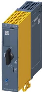
avviatore invertitore fail-safe High Feature; con commutazione elettronica; protezione elettronica da sovraccarico fino a 1,1 kW / 400 V; campo di regolazione 0,9 ... 3A; PROFEnergy; opzionale: modulo 3DI/LC
