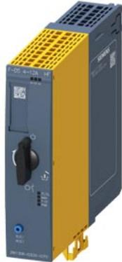
avviatore diretto fail-safe High Feature; incl. ventilatore (3RW4928-8VB00); con commutazione elettronica; protezione elettronica da sovraccarico fino a 5,5kW / 400V; campo di regolazione 4,0 ... 12A; PROFlenergy; opzione: modulo 3DI/LC
