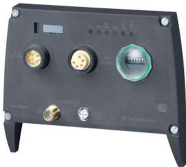
avviatore motore SIRIUS M200D modulo di comunicazione PROFIBUS DP rimovibile connettore di bus 2 x M12 con collegamento in cascata collegamento per energia 24 V 2 x 7/8" con collegamento in cascata resistenza terminale di chiusura bus integrato tramite modulo tecnologico 3RK1395\* impiegabile come avviatore motore M200D con comunicazione
