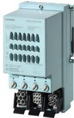
ET 200pro ERSE/RSSE HF avviatore invertitore elettronico, con commutazione elettronica (graduale) protezione totale motore costituita da: protezione elettronica da sovraccarico + termistore 3 AC 400 V/0,9kW 0,15 A...2,00 A contatto del freno AC 400 V 4DI Han Q4/2 - Han Q8/0
