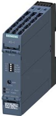
modulo AS-i SlimLine Compact SC22.5, IP20, analogico, 4AI-C/V morsetti a vite 4x ingressi analogici ingressi commutabili C/V larghezza costruttiva 22,5 mm
