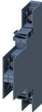
blocchetto di contatti ausiliari, laterale, 1 NO + 1 NC, a sinistra: 51/52, 63/64, a destra: 31/32, 43/44, via di corrente: 1 NC, 1 NO, collegamento con capocorda ad occhiello, per contattori 3RT2 e contattori ausiliari 3RH2
