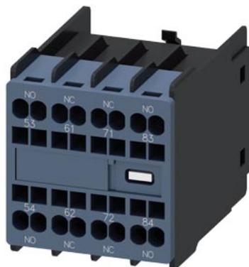
blocchetto di contatti ausiliari, sul lato frontale, 2 NO + 2 NC, 53/54, 61/62, 71/72, 83/84, via di corrente: 1 NO, 1 NC, 2 NC, 1 NO, morsetti a molla, per contattori 3RT2 e contattori ausiliari 3RH2
