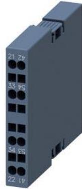
blocchetto di contatti ausiliari, laterale, 1 NO + 1 NC, a sinistra: 41/42, 53/54, a destra: 21/22, 33/34, via di corrente: 1 NC, 1 NO, morsetti a molla, per contattori 3RT2 e contattori ausiliari 3RH2
