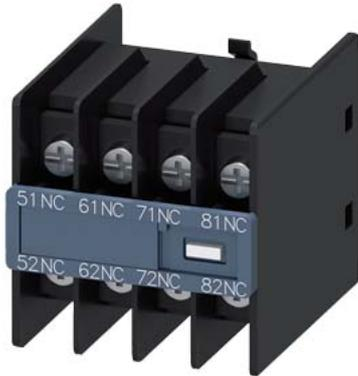
blocchetto di contatti ausiliari, sul lato frontale, 4 NC, 51/52, 61/62, 71/72, 81/82, via di corrente: 1 NC, 1 NC, 1 NC, 1 NC, collegamento con capocorda ad occhio, con codifica fisica, solo con contattori ausiliari 3RH2140 e 3RH2440 combinabili (secondo EN 50011)
