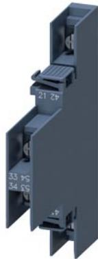
blocchetto di contatti ausiliari, laterale, 1 NO + 1 NC, a sinistra: 41/42, 53/54, a destra: 21/22, 33/34, via di corrente: 1 NC, 1 NO, collegamento con capocorda ad occhio, per contattori 3RT2.1
