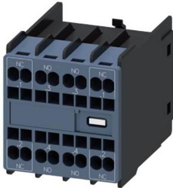
blocchetto di contatti ausiliari, compatibile con l'elettronica, sul lato frontale, 2 NO + 2 NC, .1/.2, .3/.4, .3/.4, .1/.2, via di corrente: 1 NC (compatibile con l'elettronica), 1 NO, 1 NO, 1 NC (compatibile con l'elettronica), morsetti a molla, per contattori 3RT2 e contattori ausiliari 3RH2
