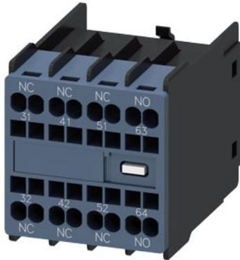
blocchetto di contatti ausiliari, sul lato frontale, 1 NO + 3 NC, 31/32, 41/42, 51/52, 63/64, via di corrente: 1 NC, 1 NC, 1 NC, 1 NO, morsetti a molla, per contattori 3RT2 e contattori ausiliari 3RH2
