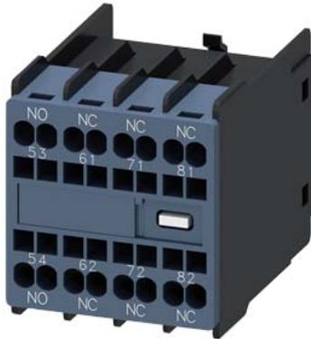
blocchetto di contatti ausiliari, sul lato frontale, 1 NO + 3 NC, 53/54, 61/62, 71/72, 81/82, via di corrente: 1 NO, 1 NC, 1 NC, 1 NC, morsetti a molla, con codifica fisica, solo con contattori ausiliari 3RH2140 e 3RH2440 combinabili (secondo EN 50011)
