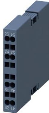
blocchetto di contatti ausiliari, compatibile con l'elettronica, laterale, 1 NO + 1 NC, a sinistra: 41/42, 53/54, via di corrente: 1 NC, 1 NO, a destra: 23/24, 31/32, via di corrente: 1 NO, 1 NC, morsetti a molla, per contattori 3RT2.1
