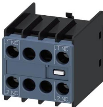
bloccetto di contatti ausiliari, compatibile con l'elettronica, sul lato frontale, 2 NC, .1/.2, --/--, --/--, .1/.2, via di corrente: 1 NC (compatibile con l'elettronica), --, --, 1 NC (compatibile con l'elettronica), morsetti a vite, per contattori 3RT2 e contattori ausiliari 3RH2
