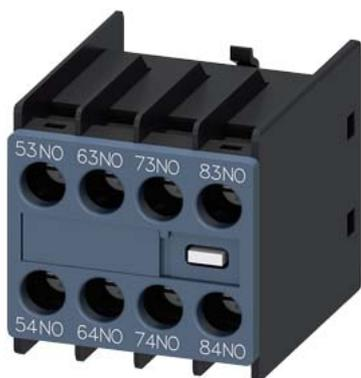
blocchetto di contatti ausiliari, sul lato frontale, 4 NO, 53/54, 63/64, 73/74, 83/84, via di corrente: 1 NO, 1 NO, 1 NO, 1 NO, morsetti a vite, con codifica fisica, solo con contattori ausiliari 3RH2140 e 3RH2440 combinabili (secondo EN 50011)
