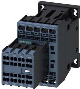
contattore ausiliario, 7 NO + 1 NC, DC 24 V, con diodo integrato grandezza costruttiva S00, morsetto a molla, blocchetto di contatti ausiliari rimovibile
