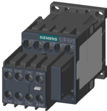
contattore ausiliario, 4 NO+4 NC, AC 230 V, 50 / 60 Hz, grandezza costruttiva S00, morsetto a vite, 2 NO + 2 NC apparecchio base / DIN EN varistore innestato
