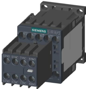
contattore ausiliario, 4 NO+4 NC, AC 230 V, 50 / 60 Hz, grandezza costruttiva S00, morsetto a vite, blocchetto di contatti ausiliari rimovibile DIN EN 50005
