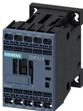
contattore ausiliario d'interfaccia, 4 NO DC 24 V, 0,85 ... 1,85\* US, grandezza costruttiva S00, morsetto a molla
