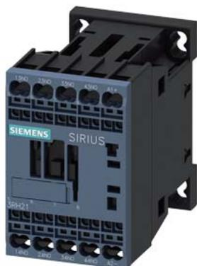
contattore ausiliario d'interfaccia, 4 NO, DC 24 V, 0,7 ... 1,25\* US, con diodo integrato, grandezza costruttiva S00, morsetto a molla adatto per uscite PLC
