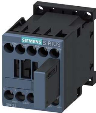
contattore ausiliario d'interfaccia, 4 NO, DC 24 V, 0,85 ... 1,85\* US, con varistore innestato, grandezza costruttiva S00, morsetto a vite
