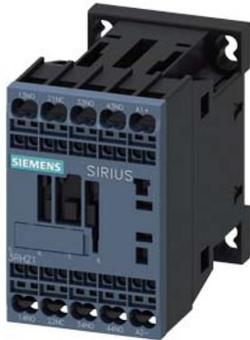
Contattore ausiliario per applicazioni ferroviarie 3NO + 1NC DC 72-125V, 0,7...1,25\*US, con varistore integrato grandezza costruttiva S00, morsetto a molla adatto per uscite PLC
