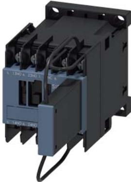
contattore ausiliario per impiego ferroviario, 2 NO + 1 NC, DC 34 V, 0,7 ... 1,25\* US, con varistore integrato, a 3 poli, grandezza costruttiva S00, collegamento con capocorda ad occhiello
