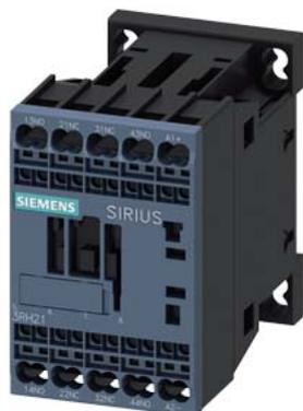
contattore ausiliario di accoppiamento per applicazioni ferroviarie, 2 NO+2 NC, DC 110 V, 0,7 ... 1,25\* US, con varistore integrato, grandezza costruttiva S00, morsetto a molla per posizione di montaggio verticale
